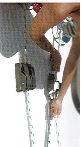
Figure 3 : La main se blesse au contact d'élément d'accastillage présentant une partie mobile. Ainsi, il convient de se maintenir à distance de toutes les poulies du bord, des winchs, du guindeau, des chariots...
